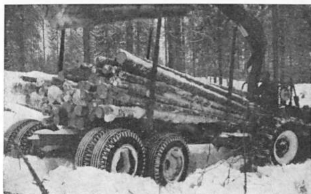
Kuva 2. 4 m havupaperipuiden kuormausta kahmaintaakkoina palstatien varresta käynnissä. — Kuvat 2—6 ottanut Metsäteho.
