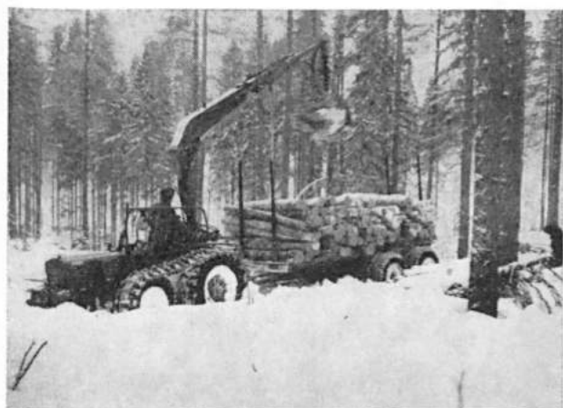
Kuva 3. 2 m koivupaperipuiden kuormausta kahmaintaakkoina palstatien varresta poikittain perävaunuun.
