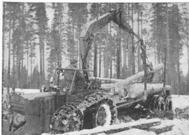
Kuva 1. Massey-Ferguson Robur -metsätraktori varustettuna HIAB 173 M Elefantti -kahmainnosturilla ja Rossön-teliperävaunulla. Sahatukkien kuormausta palstatien varresta Pielisjärvellä. — Valok. T. Kapari.
