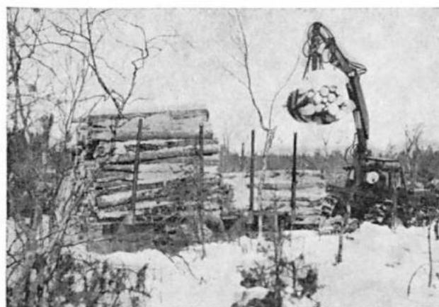
Kuva 5. 2 m paperipuiden kuormausta pitkittäispinoihin perävaunuun. Pinojen kuormausta helpottuu vetoaisan pituutta hydraulisesti säätämällä.
