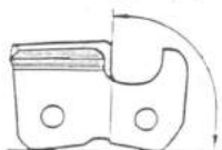
Säätöhampaan ja leikkuuhammas- kourun välinen tasoero 0,50–0,75 mm
