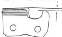
Säätöhampaan ja leikkuuhammas- kourun välinen tasoero 0,50–0,75 mm
