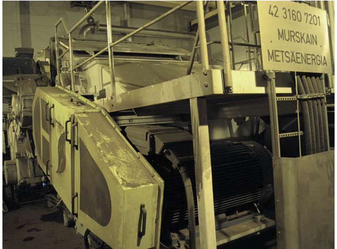
↑ Tutkimuksessa ollut Kaukaan Voima Oy:n Saalasti Murska 1224 HF -murskaimessa oli umpiteräksinen roottori kiinteillä murskausterillä. Roottorin halkaisija oli 1,2 metriä ja leveys 2,4 metriä. Roottorin pyörimisnopeus oli 600 kierrosta/minuutti.
