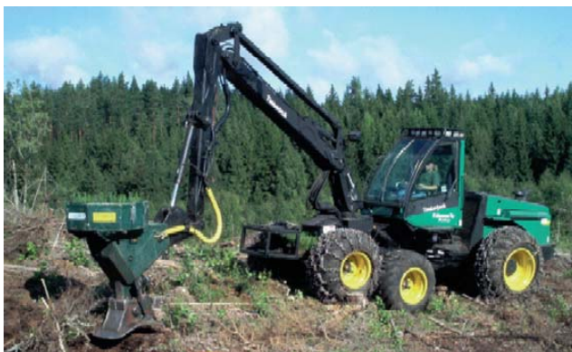
Bräcke-istutuskone hakkuukoneessa (kuva Robur Maskin Ab)
