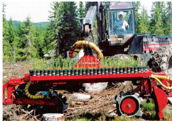
EcoPlanter-istutuskone hakkuukoneessa (kuva Partek Forest Oy Ab)
