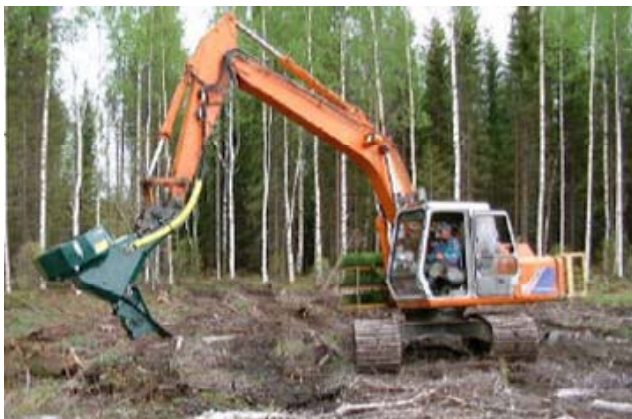
Bräcke-istutuskone kaivukoneessa (kuva Robur Maskin Ab)
