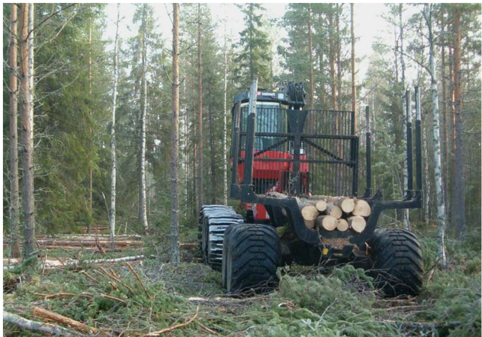
KUVA 2. Seurantatutkimuksessa ensiharvennuksella Valmet 801 Combi -korjureilla hakattiin yleensä ajouralinja samanaikaisesti välialueiden harvennuksen kanssa. Valtaosa hakatusta puutavarasta kasattiin ajouran varteen. Pienikertymäisiä puutavaralajeja kuormattiin suoraan kuorman pohjakuormaksi. Valokuva: Metsäteho Oy
