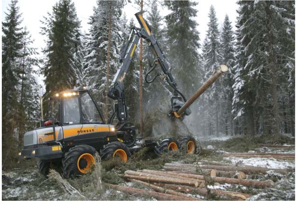
KUVA 1. Ponsse Wisent Dual -korjuri hakkaamassa pätehakkuukuusikkoa. Kun oli tiedossa, että sankka lumisade on tulossa, kuormatraktori-varustus vaihdettiin korjuriin ja hakattu puutavara pyrittiin kuljettamaan leimikosta varastolle ennen lumisateen alkua. Valokuva: Ponsse Oyj
