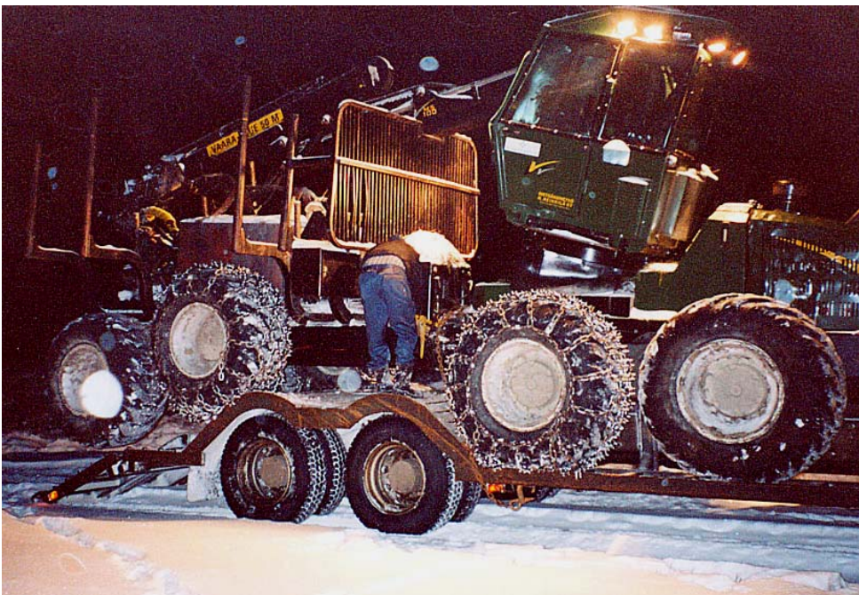
KUVA 17. Pika 828 Combi -korjuria sidotaan siirtoautoon lumisateen alka- essa. Valokuva: Metsäteho Oy
