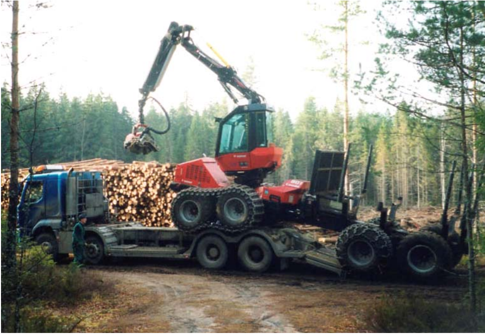
KUVA 16. Valmet 801 Combi -korjuria ajetaan siirtoautoon. Valokuva: Metsäteho Oy
