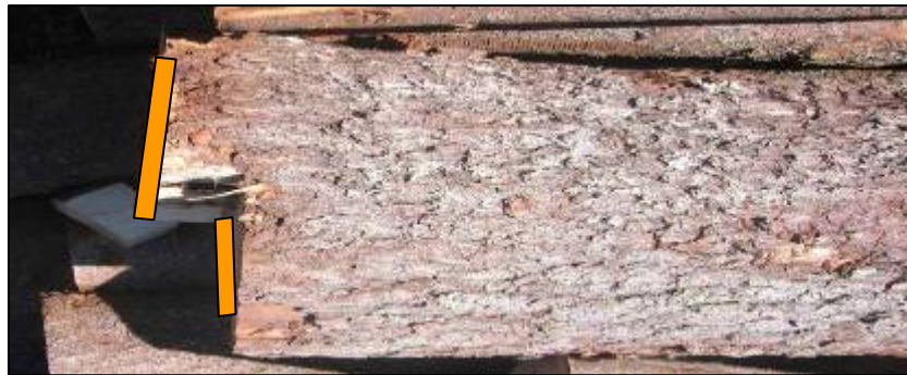
KUVA 8. Vinosahausta ja lipaa voivat aiheuttaa suuria mittavirheitä tukkien pituusmittauksessa sahalta. Kuvassa valokennon säteen mahdolliset kulkukohdat on merkitty keltaisella.
