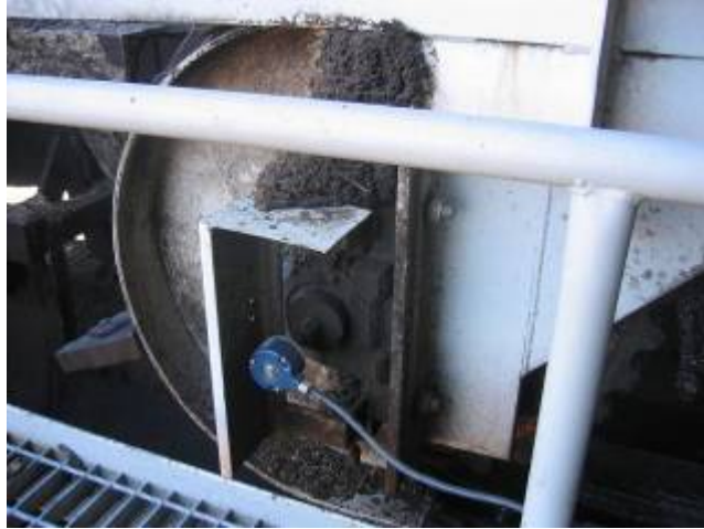
KUVA 6. Pulssianturi tukkikuljettimen taittopyörän akselissa.
