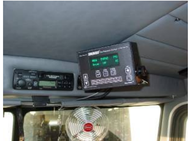
Kuva 11. TPC Internationalin järjestelmän näyttö- ja ohjausyksikkö sijaitsee auton ohjaamossa.
