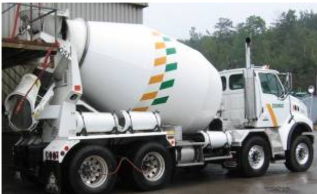
Kuva 4. Rengaspaineiden säätöjärjestelmällä varustettu betoniauto Kanadassa.
