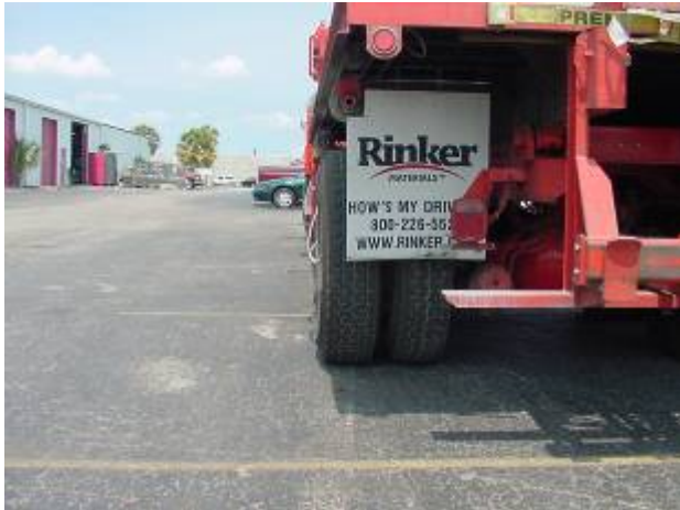
Kuva 10. Takaa katsottuna nähdään, että ilmalitkut tulevat vain vähän auton sivureunaa ulommaksi.
