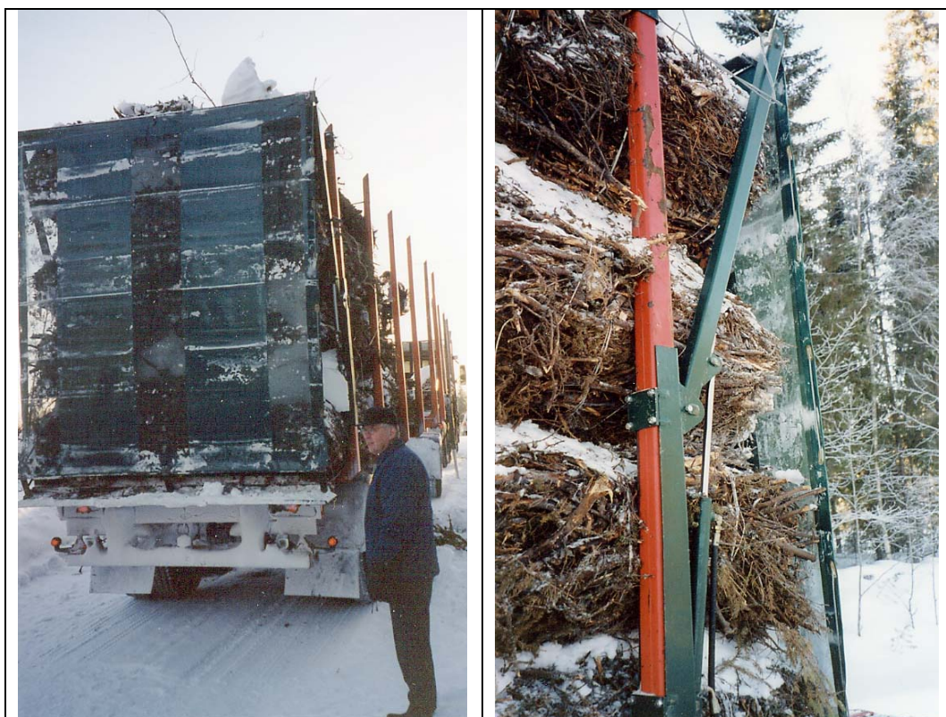
Kuva 8. Kuormatilan päätysermit, jotka nostetaan ja lasketaan hydraulisylinterien avulla. Kuvassa sermien kehittäjä Sakari Mononen Karelian Puu ja Metalli Oy:stä.
