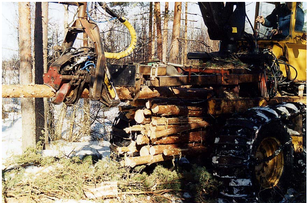
Kuva 7. Korjurin kuormatilaan mahtuu noin 2,5 m 3 kuitupuuta. Kuvassa karsittua runkoa työnnetään kuormatilaan.
