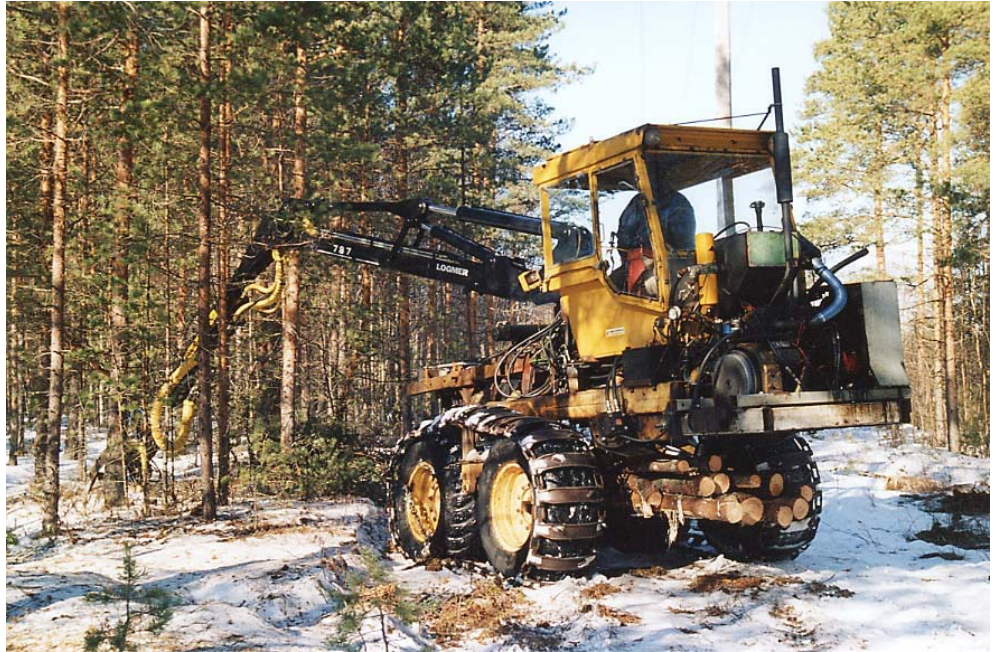
Kuva 6. Syrjän prototyypikorjurissa kuormatila on sen rungon alla.
