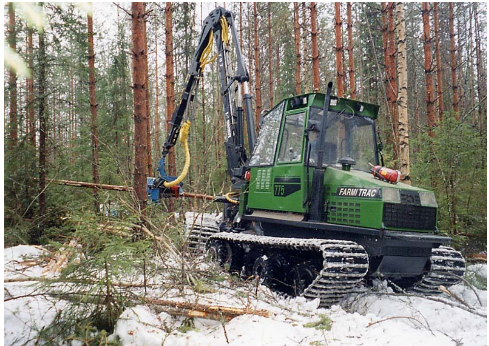
Kuva 3. Aikatutkimuksessa Keto Forst Energy -hakkulaite oli Farmi Trac 775 -pienharvesterissa.
