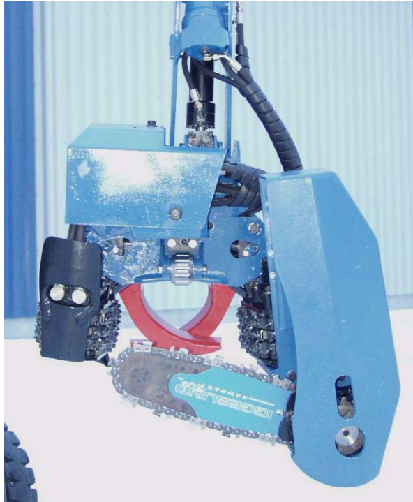
Kuva 1. Keto Forst Energy -hakuulaitteen 10 mm paksu terälaippa. Kuva: Kone-Ketonen Oy
