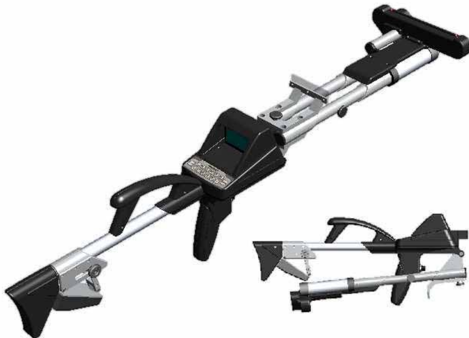
Kuva 3. Laserrelaskoopin III prototyyppi. Laitteen runkoon on kiinnitetty leveydeltään säädettävä hahlo vakioetäisyydelle silmästä. Hahlon liukumekanismiin alla on laseretäisyysmittari. Rungon keskiosassa on prosessointiyksikkö sekä näyttö. Prosessointiyksikön edessä on tähtäinlevy. Kompassi ja kaltevuusmittari ovat rungon alapuolella laitteen perässä.
