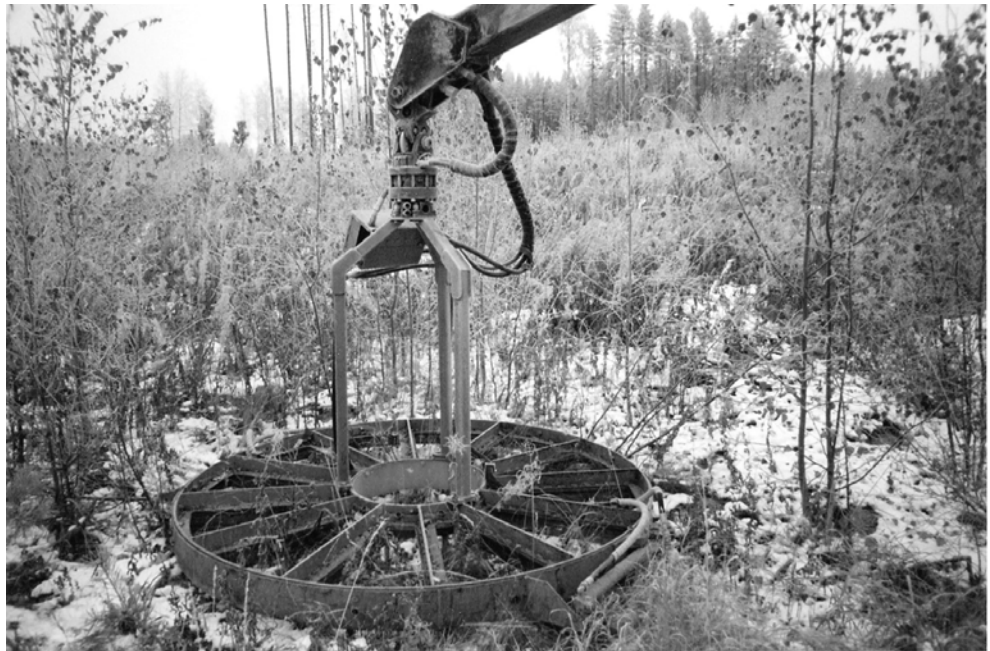
Kuva 1. Taimikonhoitolaite Savitaipaleen työmaalla.
