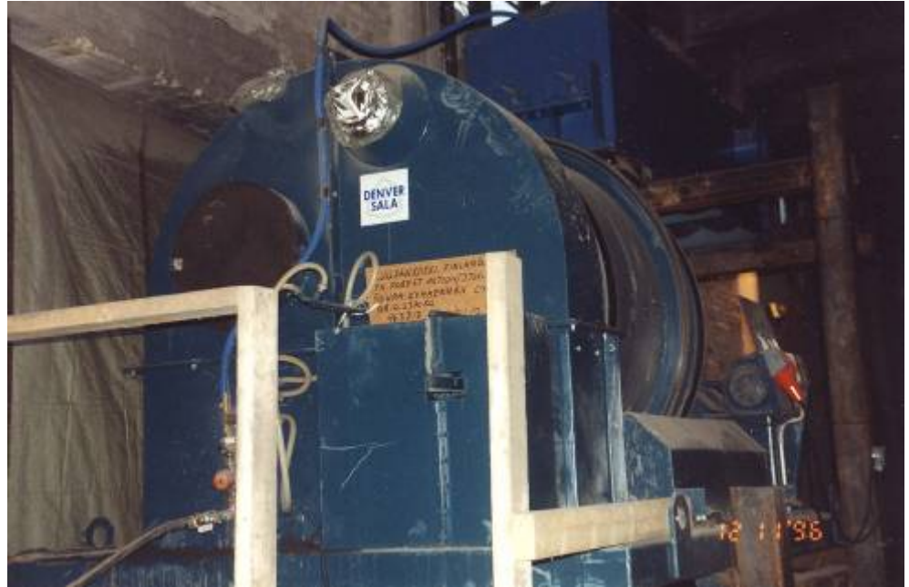
Kuva 8. Tuhkan rumpurakeistusta kokeillaan UPM-Kymmenen Kuusankosken tehtailla kesällä 1996.
