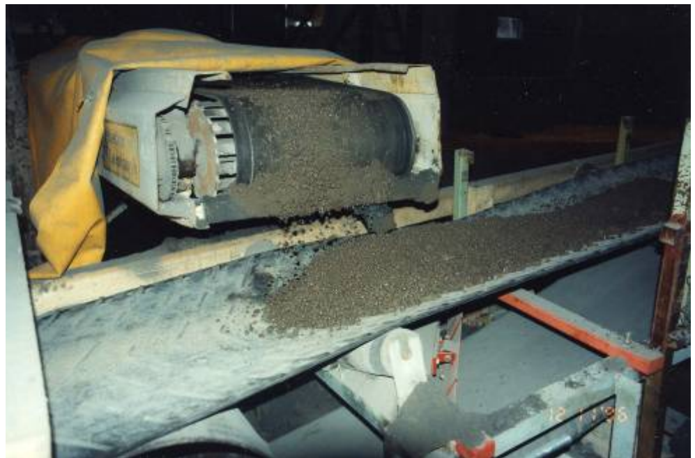
Kuva 9. Tuhkarakeet kovettuvat hihnakuljettimilla siirron aikana varastointikelpoisiksi.
