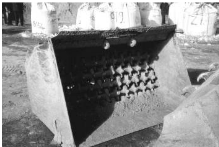
Kuva 4. Itsekovetustuhkan kuormauksessa käytetty seulakauha. Taustalla lannoitustutkimuksia varten säkitettyä tuhkaa.
