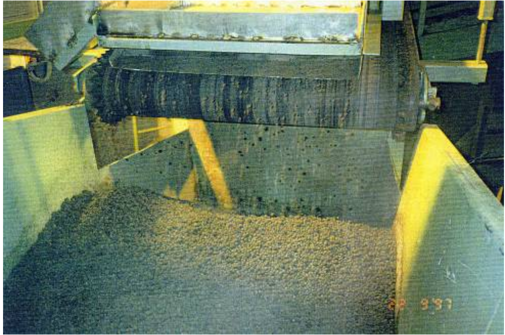
Kuva 7. Lautasrakeistimella tuotettuja tuhkarakeita hihnakuuljetimella Enocellissa.
