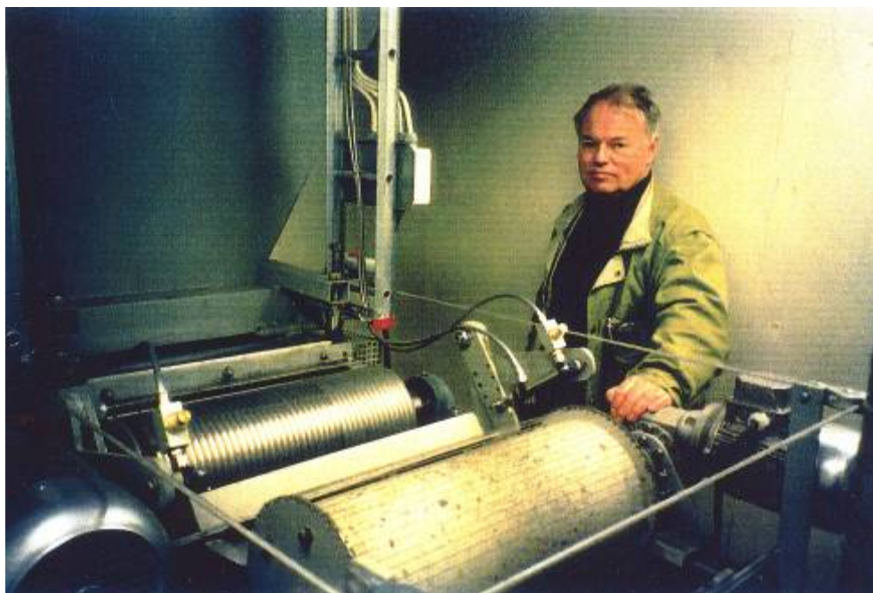
Kuva 10. Ruotsissa kehitetty tuhkan valssausyksikkö. Kuvassa taaempi rumpu on uritettu ja se tiivistää ja muotoilee tuhkan nauhoiksi, etummainen rumpu on varustettu langoilla, jotka pätkivät tuhkanauhat.
