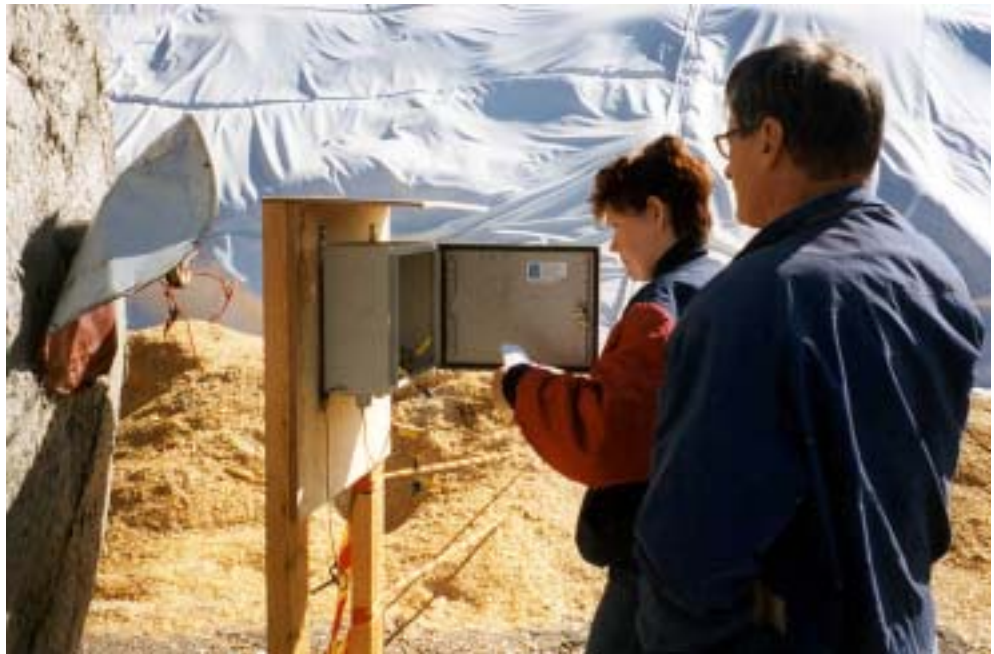
Puukasan lämpötilatietoja otetaan talteen.
