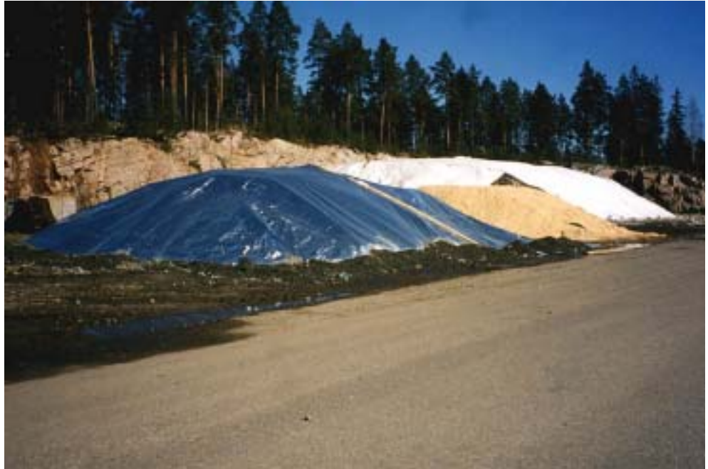
Kokeilukasat valmiina huhtikuussa. Etummaisena matalaemissiopinnoitettu lumikasa, keskimmäisenä purulla peitetty lumikasa, takimmaisena eristepeitteellä peitetty puukasa.
