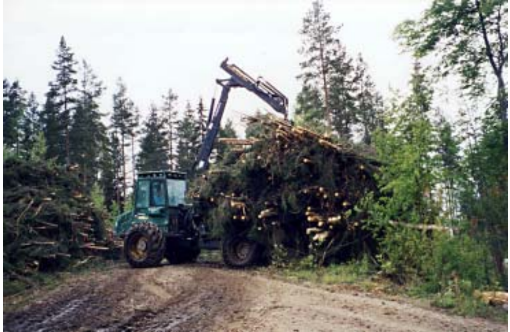
Kuva 1. Koneen 1 kuljettaja käytti kuorman teossa poikittaisladontatekniikkaa, mikä suurensi kuorman kokoa.
