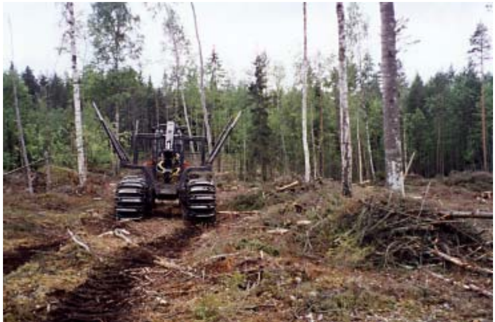
Kuva 4. Koneella 4 karikat voitiin kallistaa sivulle, mikä kasvatti kuormatilaa jopa 50 %.
