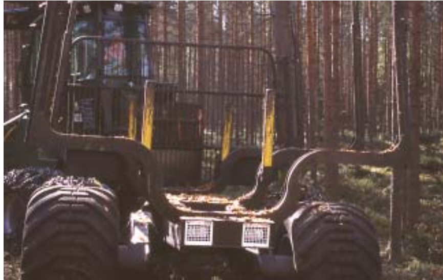
Kuva 25. Lajittelun yleistyessä myös sekakuormina ajo lisääntyy. Erilaiset lisäkarikat helpottavat puutavaralajien erilläänpitoa. Kuvassa Pika 728 Combi -korjurin kuormatila.
