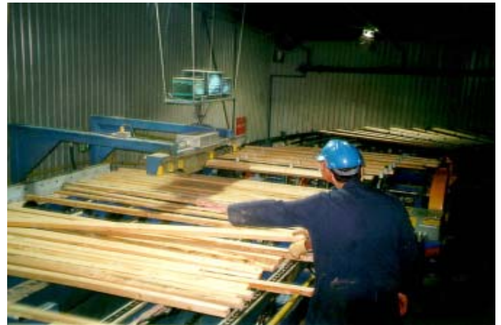
Harvennuspuun sahausta pelkkahakkuri-pyörösahalla, päätuotteena 2 x 3-tuumainen rakennuspuutavara.
