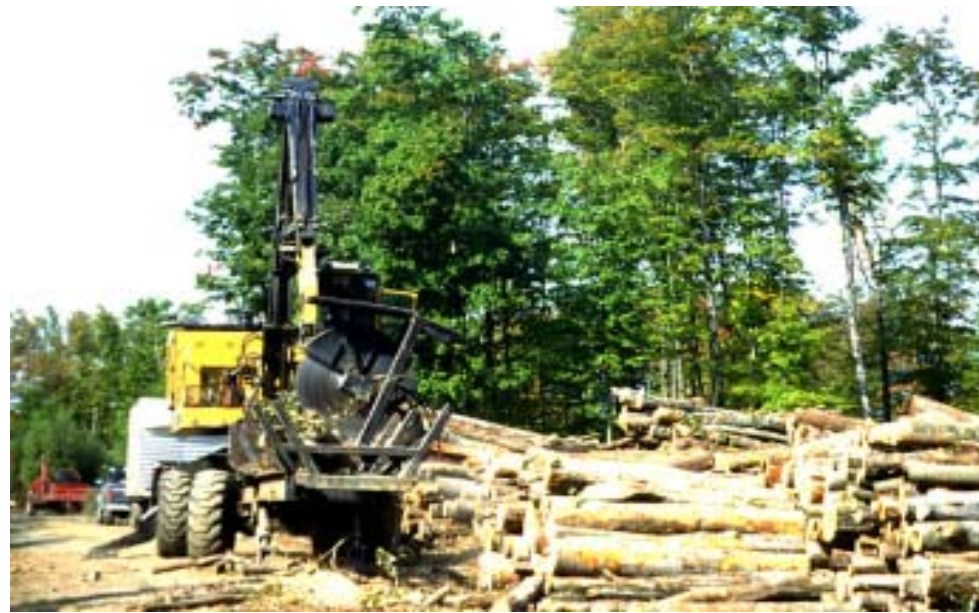
Kokopuiden juonto-, kasaus-, karsinta- ja katkontakoneet päätehakuualalla.
