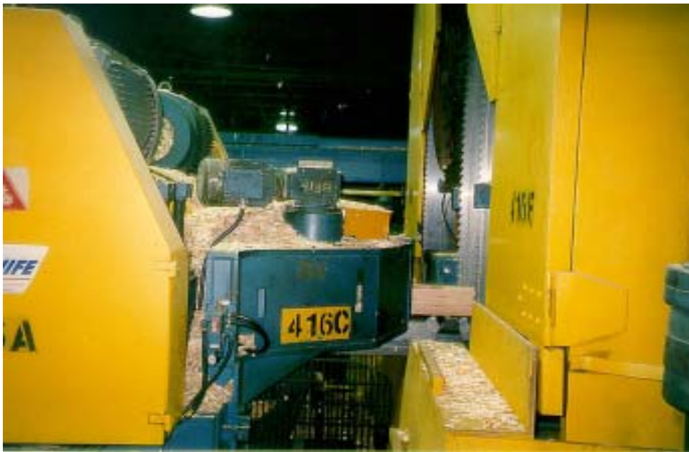
Harvennuspuun sahausta pelkkahakkuri-pyörösahalla, päätuotteena 2 x 3-tuumainen rakennuspuutavara.
