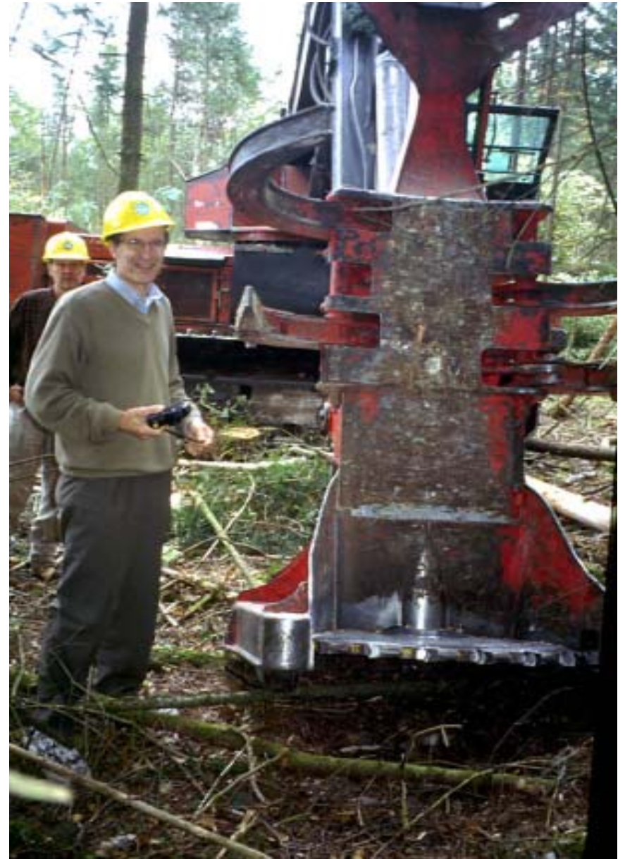
Järeä tela-alustainen kaato-kasauskone päätehakkuutyömaalla.
