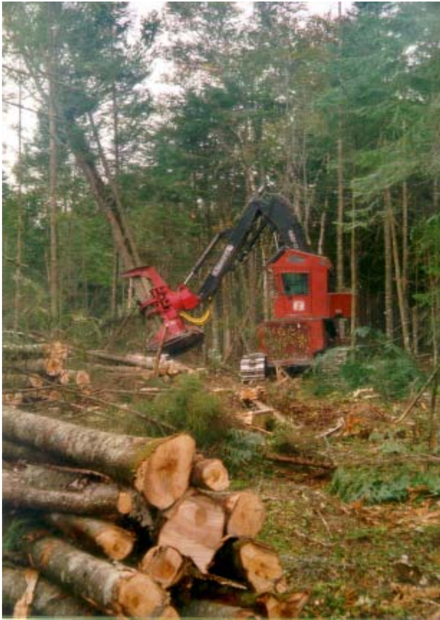
Järeä tela-alustainen kaato-kasauskone päätehakkuutyömaalla.
