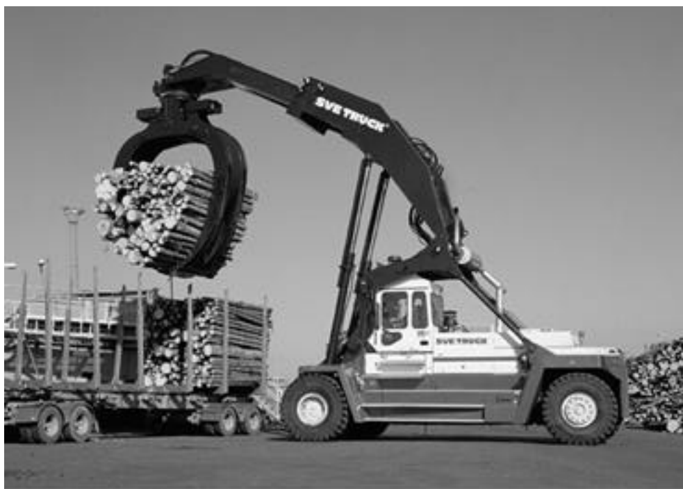
Kuva 13. Päältä tarttuvassa kurottajassa vaaka perustuu venymäliuska-antureihin.
