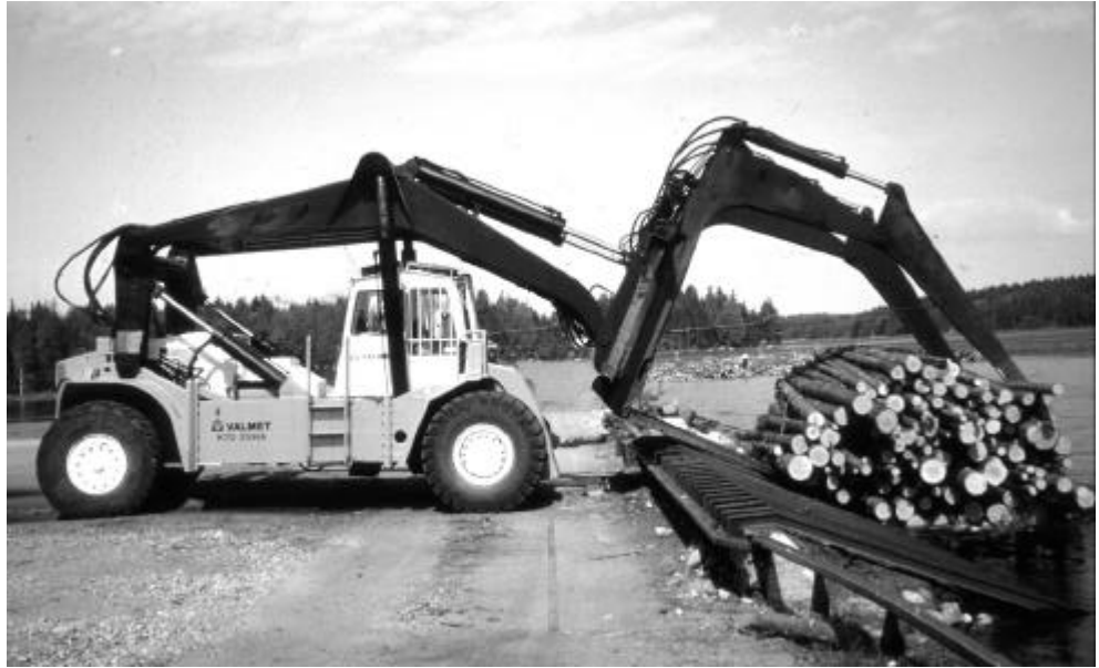
Kuva 14. Sivulta tarttuvassa kurottajassa punnitus perustuu nostohydrauliikan paineen mittaamiseen.
