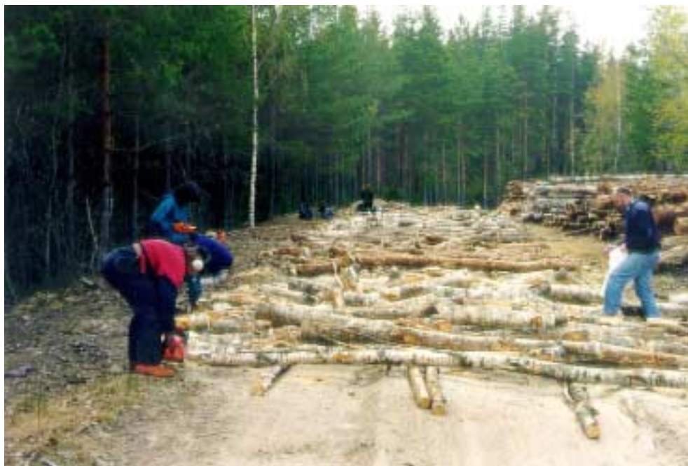
Näytteiden ottoa litissä. Varastopinoista (oikealla) puut otettiin esille puuaineen laadussa tapahtuneiden muutosten määrittämiseksi. Valokuvat Metsäteho Oy
