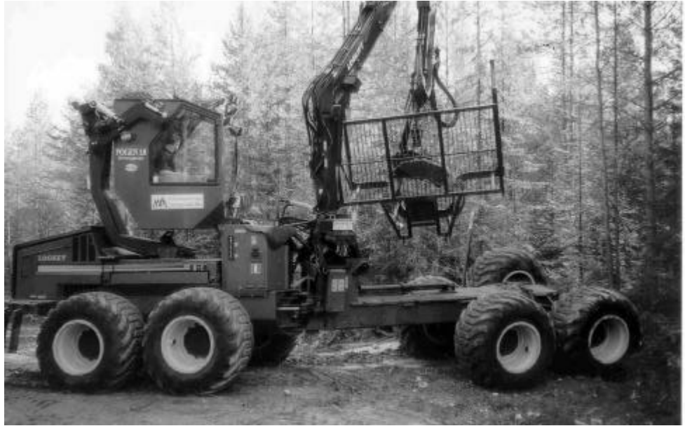
Kuva 2. Ruotsalainen P-O Gunnarssons Entreprenad'in omistama Logset SRG 6E -korjuukone varustettuna riippuvalla Pendo-ohjaamolla ja pikakiinnitteisillä pankoilla ja etusermillä.
