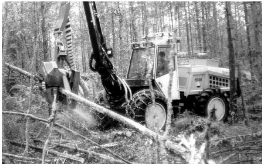
Kuva 3. Sampo-Rosenlew 1046 -hakuukone sopii erityisesti harvennus-hakkuisiin.
