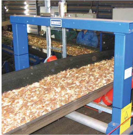
Hakkeen massavirtamittaus gammasäteilyn avulla. Sama mittauslaitteisto voitaisiin kalibroida kosteudenmäärittämiseen.
