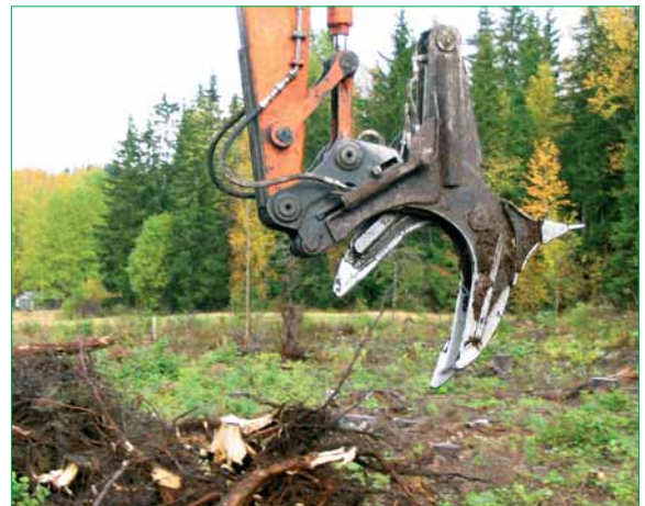
The Väkevä Stump Processor lifting head tested in the time study. Photos: Kalle Kärhä / Metsäteho Oy.
